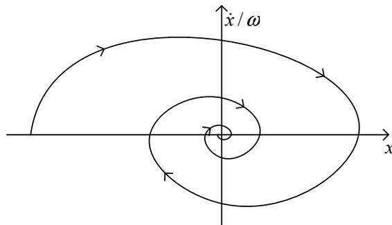
La trajectoire de phase est une spirale logarithmique. Le centre  $O$  du repère est un attracteur : quelles que soient les conditions initiales, l'oscillateur se rapproche de  $O$ .
