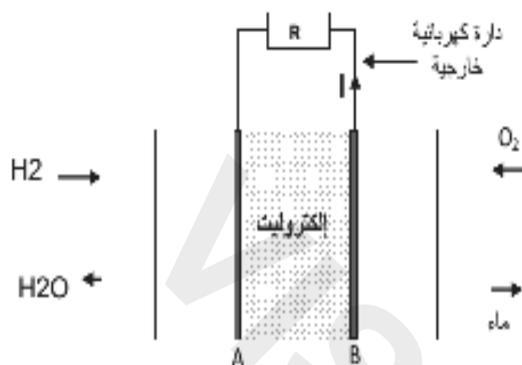
توضح التبيانة مبدأ الاشتغال الكهركيميائي لعمود ذي محروق.
