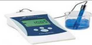
Le pH-mètre : il donne une valeur précise du pH d'une solution aqueuse
